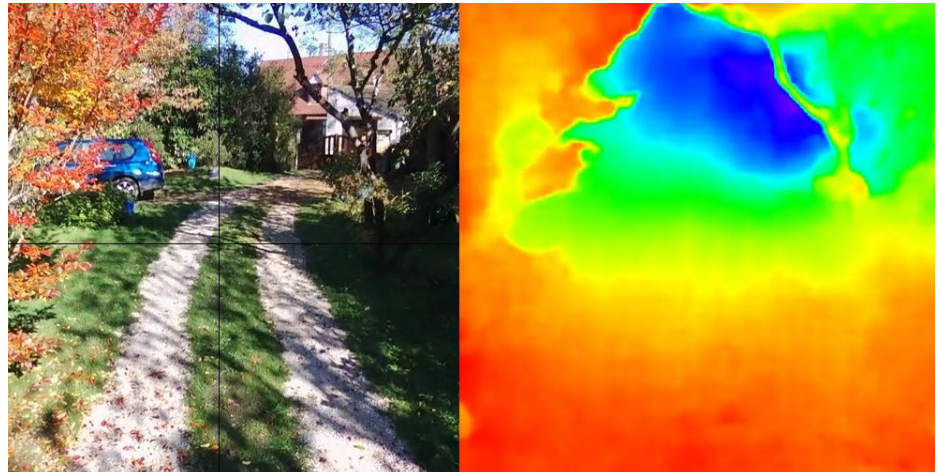
Exemple de résultat de détection d'obstacle à partir de réseaux de neurones. Les objets les plus proches sont en rouge et les plus lointains en bleu. Source : Clément Pinard, Laure Chevalley, Antoine Manzanera et al. End-to-end depth from motion with stabilized monocular videos. arXiv preprint arXiv:1809.04453 , 2018.
